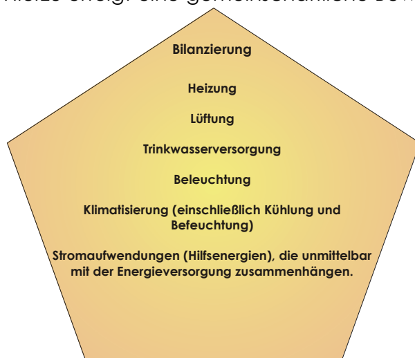
Abbildung 1: Energetische Bilanzierung von Nichtwohngebäuden nach DIN V 18599-1
