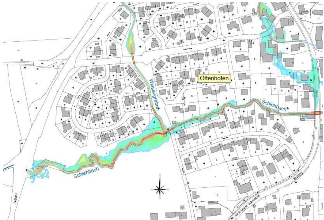
Abb. 7 Ausschnitt: Interkommunales Integrales Hochwasserschutz- und Rückhaltekonzept (HQ 100), Lageplan 5 Bestand Ottenhofen, Quelle: Sehlhoff GmbH 2015
