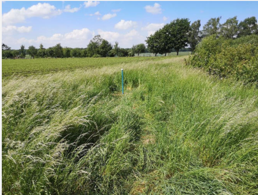
Foto 3 Fertiggestellte Grundwassermessstelle GMS-01 im Bereich südlich des Regenrückhaltebeckens. Foto vom 24.05.2024.
