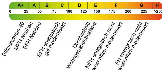
Die modellhaft ermittelten Vergleichswerte beziehen sich auf Gebäude, in denen die Wärme für Heizung und Warmwasser durch Heizkessel im Gebäude bereitgestellt wird.
